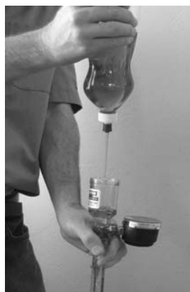
塑膠擠壓瓶進行填充
