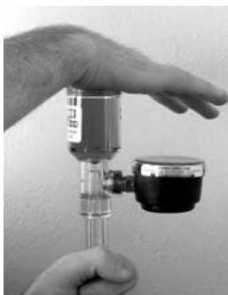
手掌敲擊管口除去氣泡
